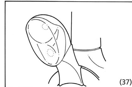
krachtige halogeen lamp, voorzien van een geïntegreerde reflector, zorgt voor meer lichtopbrengst en heeft een langere levensduur. Het geheim zit in de lens. Vroeger zat deze in het glas aan de voorzijde van de lamp. Nu zit de lens in de spiegelende parabool achter de lamp. Hierdoor is de lichtopbrengst superieur. De koplamp op de vouwfietzen kan verschillen in uitvoering.
