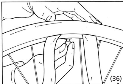
9. Remettez le pneu à la main. Les démonte-pneus peuvent provoquer des crevaisons. Commencez à partir de la valve et faites attention à ne pas coincer la chambre à air entre la jante et le pneu.
